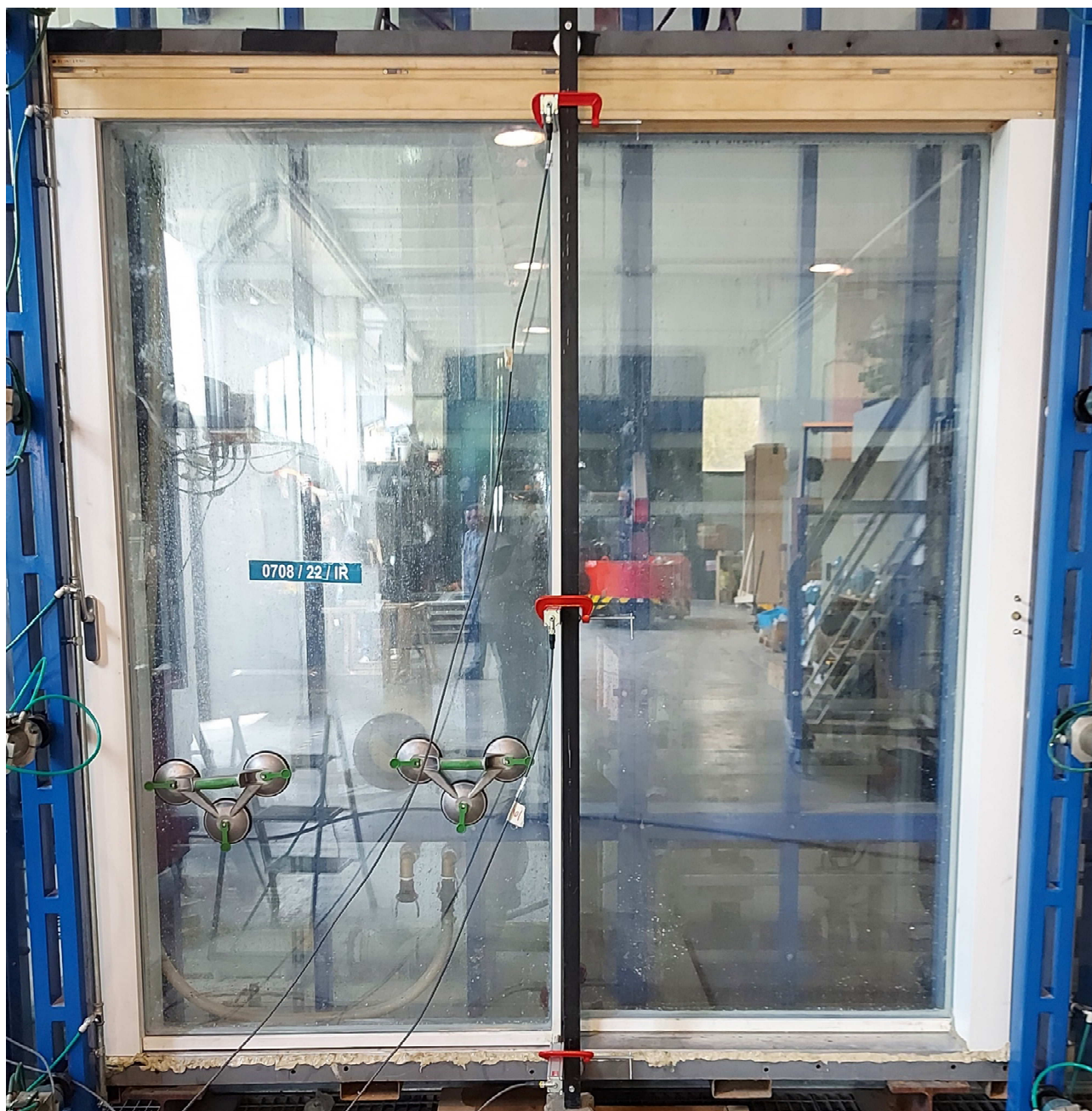
Foto 3: Campione sottoposto a prova durante i test di resistenza al carico del vento
