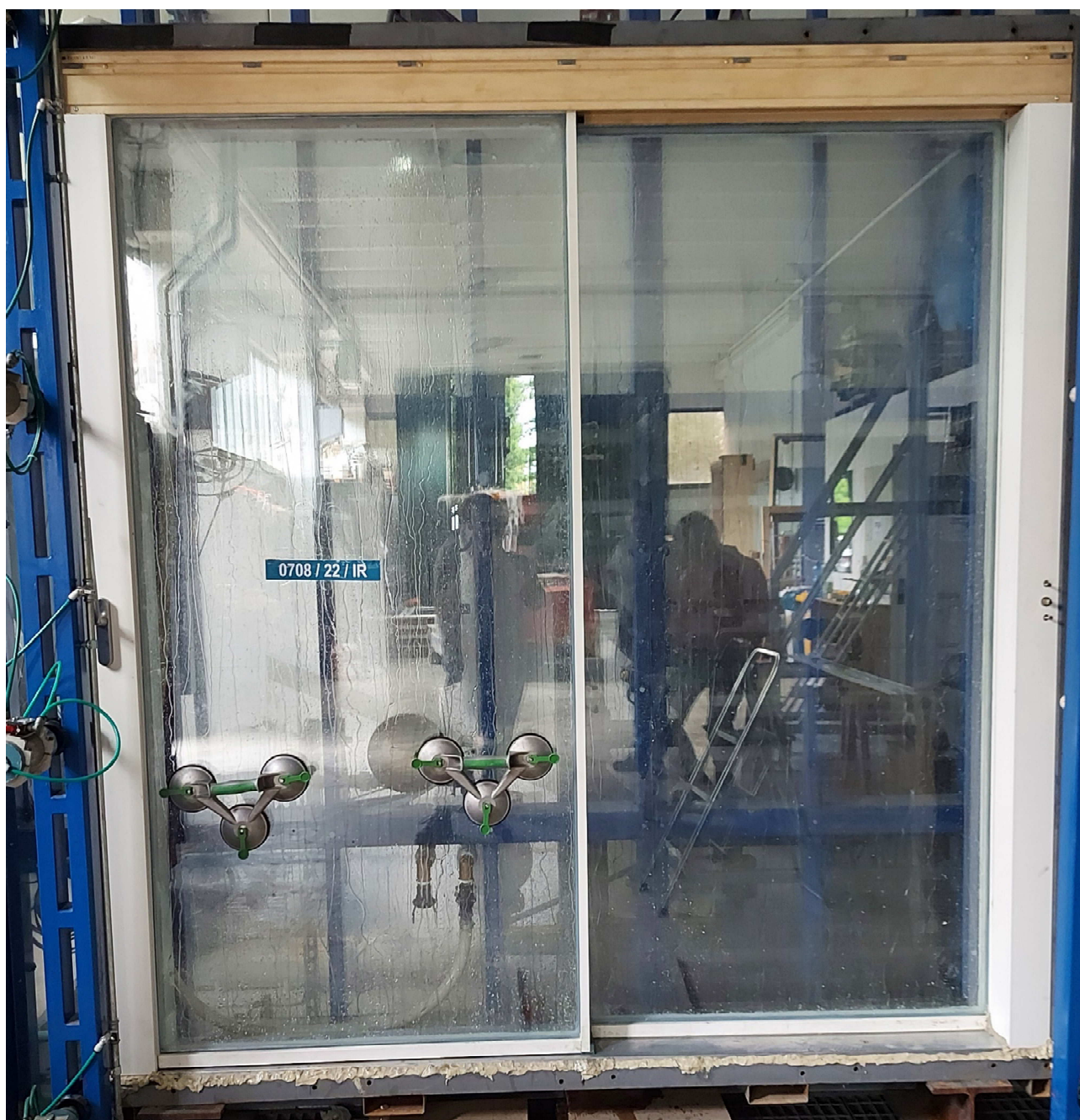
Foto 2: Campione sottoposto a prova durante i test di tenuta all'acqua
