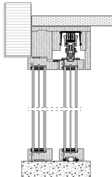
Telaio in legno/alluminio triplo vetro con serramento in luce e cappotto esterno
