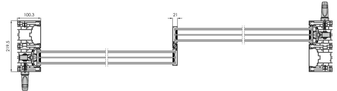
Telaio in alluminio triplo vetro con sollevamento motorizzato
